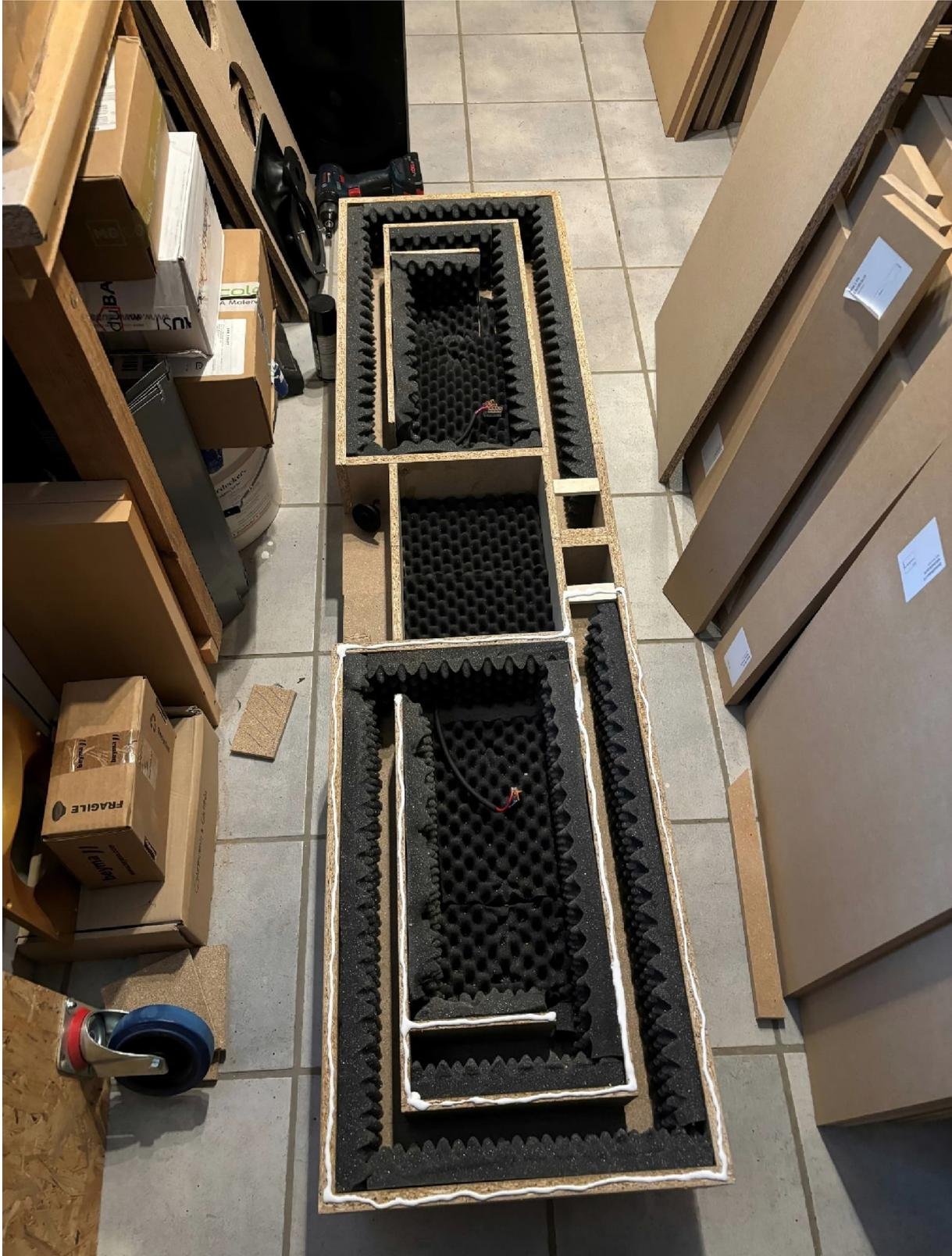
Das Sonofil wird im MT/HT Gehäuse zusätzlich zum Noppenschaum seitlich platziert.
